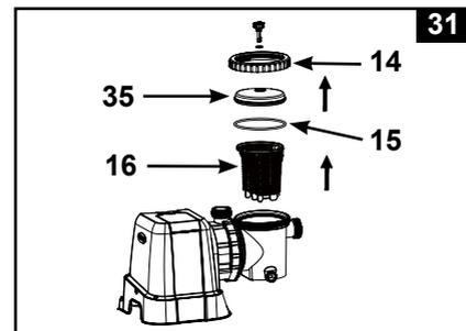
5. Leeren Sie den Korb und spülen Sie ihn mit einem Gartenschlauch aus, benutzen Sie eine Plastikbürste um gegebenenfalls Ablagerungen aus dem Korb zu entfernen. Verwenden Sie keine Metallbürste.
